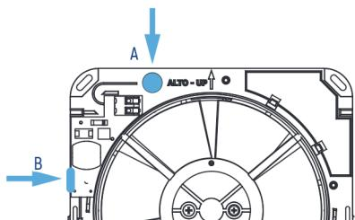
Aprire il foro (A) predisposto per il passaggio del cavo; nel caso di collegamenti esterni non sotto traccia, aprire il passaggio laterale (B) sia sul porta motore, che in corrispondenza sul coperchio.
