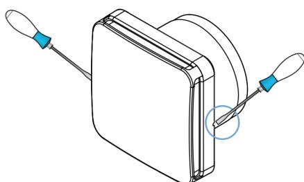
Sganciare il coperchio dal porta motore premendo sui 2 fori laterali mediante un piccolo cacciavite.
