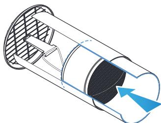
Inserire lo scambiatore di calore portandolo fino alla fine del tubo interno.
